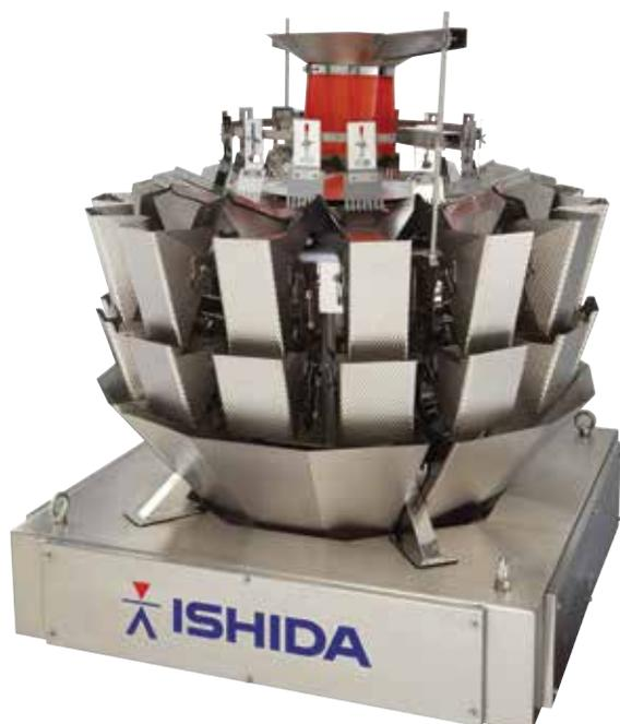
Die zuverlässige Lösung für das automatische Verwiegen eines großen Spektrums freifließender Produkte. Dank ihrer einfachen Bauweise ist die Maschine leicht zu bedienen und zu reinigen. Qualität und Wiegegenauigkeit sichern die Minimierung des Produktverlusts eine schnelle Amortisation. Die Bedienoberfläche und Menüführung ist einfach gehalten und die bis zu 100 verschiedenen Voreinstellungen machen einen schnellen Produktwechsel möglich.
